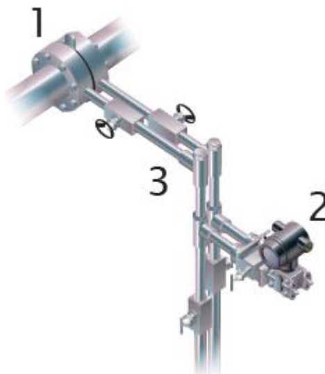
شکل ۱,۷,۱-ا- نصب فلومتر اختلاف فشار سنتی عنصر ابتدایی مجزا، سمت چپ بالا، عناصر سومی (خطوط ضربه، شیر ها، کانکتور ها و چند راهه) و عنصر ثانویه، ترانسمیتر، سمت راست نقطه مرکزی دارد.
